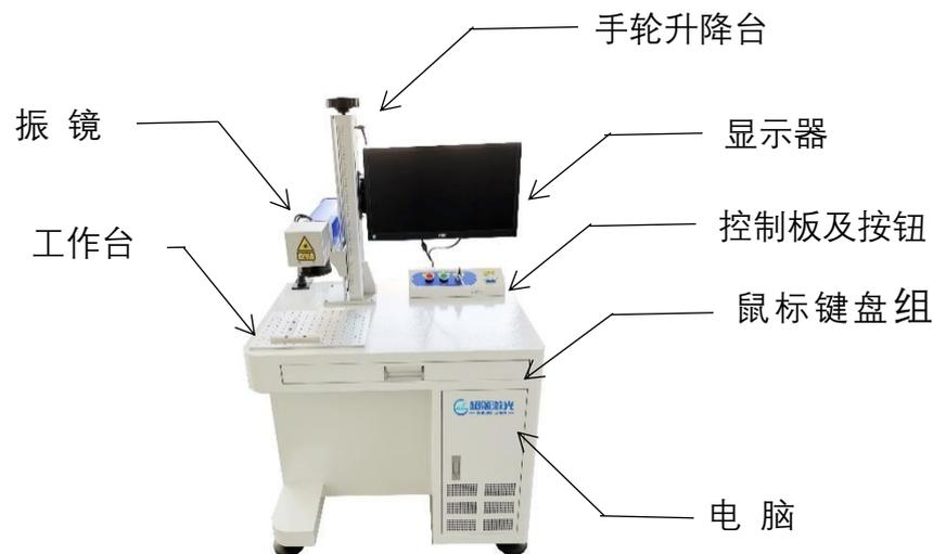
1. 整机正面示意图如图 5-1 所示：
